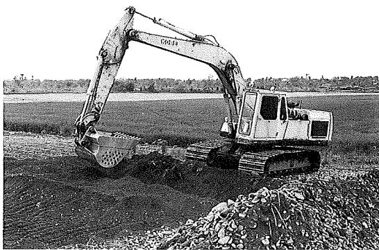
写真10) 掘削機による除礫
