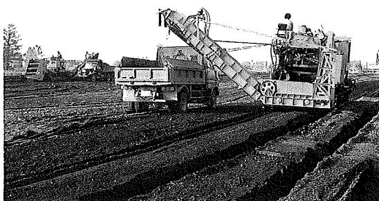
写真4) 厚層処理では石礫量が多いので、アンローディングコンベヤを装備し、伴走するトラックに積載してしまうものとしている。石礫の堆積場との距離に關係するが、通常1台のストーンピッカに3台のトラックとしている。石礫の搬出が施工費を多くするとされ、石礫を30cm下の下層に埋設する方式が検討された。これは技術的には可能であり、これからに期待したい。
