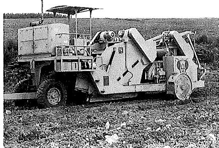
写真1) 厚層処理ストーンピッカ1号機
