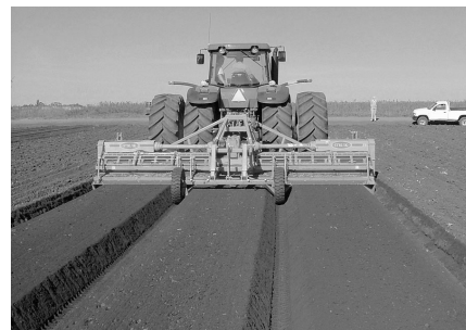
3列分の畝を造成するオランダのストラーク社製畝立機。南アフリカの野菜農場で売れている
