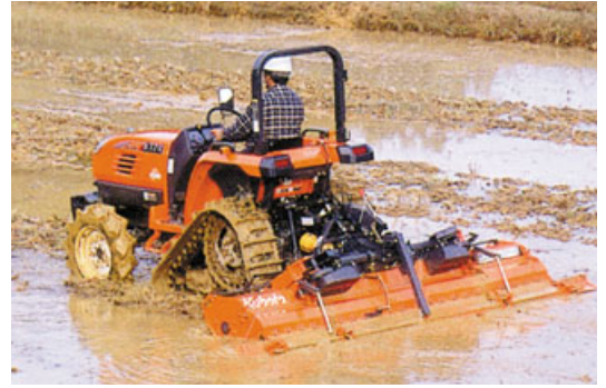
パワクロで代かきするとデコボコが少なくなり、田植え精度が向上する
