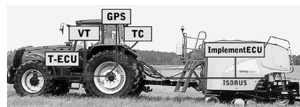
T-ECU (トラクタ電子制御装置) / VT (ヴァーチャル端末) / TC (タスクコントローラ) / Implement ECU (作業機電子制御装置)
