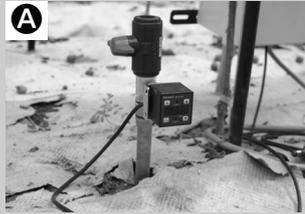
▲出力の付いていないpFメータに、出力付きの圧力センサを取り付けた。
