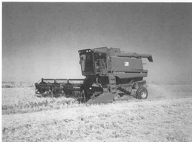
刈り幅5mの大型コンバインによる稲刈り
