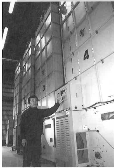
収穫した粳は60石の循環型乾燥機に張込まれ20% まで乾燥する
