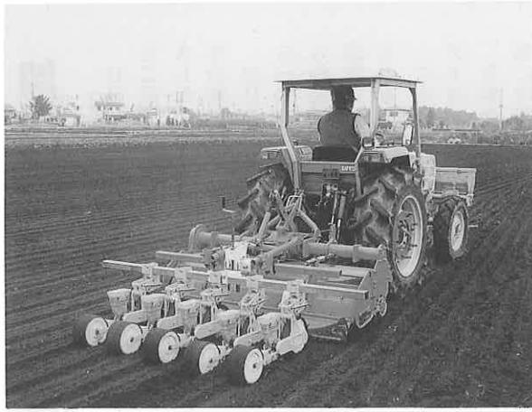
28馬力のトラクタで前部にライムソーワを付け、後部には作業幅140cmのロータリに5条の播種機をセットしての作業（条間30cm）
