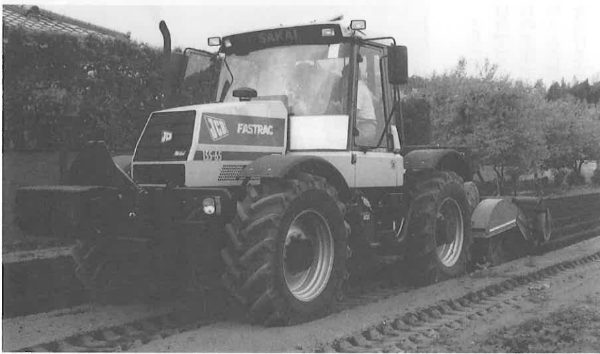
石川さんはJCBのトラクタに注目している。その高馬力だけでなく、時速60kmで走れる高速移動能力にである。業者は北海道の酪農家をお客だと思っているが、府県の請負いをする人や、各地に出作りしている野菜農家ほどそれが必要なのだ。微速装置が付けば石川さんは購入したいといっている（石川さんの圃場で4連のトレンチャー作業）
