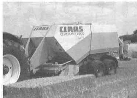
20mm長で作物を切断するファインカット装置が付いたクラスのクアンドラント2200角型ビッグベアラ
