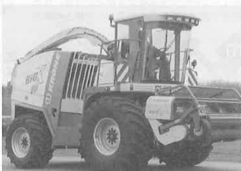
路面走行燃費25%削減に成功した、自走式モア・ビッグMと自走式フォレージハーベスタ・ビッグX（クローネ社）
