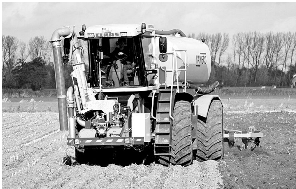
オルデンホフ社は、「ゼリオン」トラクタに機体長が長いスラリインジェクタを直装するため、クラブステアリング機能は重要。
