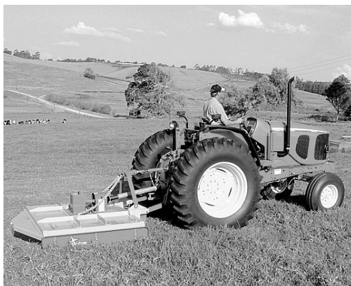
刈り取られた草が草マルチになり、草刈り機の作業幅一杯に均一に散布される。
