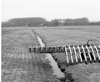
散布バーの10の区画は、それぞれ単独で昇降する。クリークを越えての使用時にとても便利だ。
