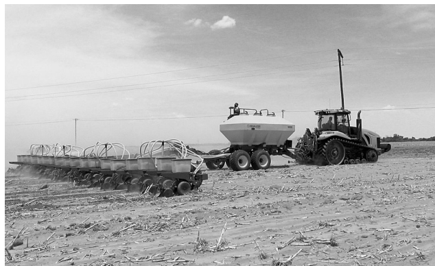
幅19mのセーボ・テク社製ツールバーには、ジョンディーア社の播種ユニットを18台連結し、1時間で100ha分のトウモロコシを播種できる。けん引するのは、AGCO社のトラクタ、チャレンジャー。
