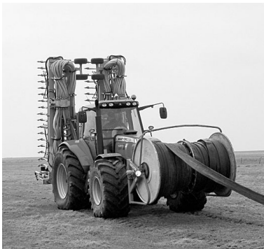
散布バーの10の区画は、それぞれ単独で昇降する。クリークを越えての使用時にとても便利だ。
