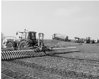
幅16.5mのアンビリカル・スプレッド・バーを、185馬力の新型マッセイファーガソン7495ダイナーVT無段変速トラクタに装着する。
