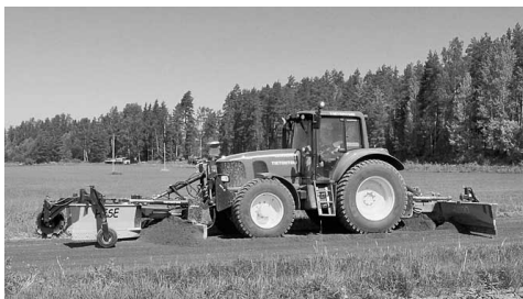
「ロード・ドクター」と呼ばれる一式の機体から地ならし用の作業機を取り外し、通常のトラクタ作業に戻るのに必要な時間は15分。
