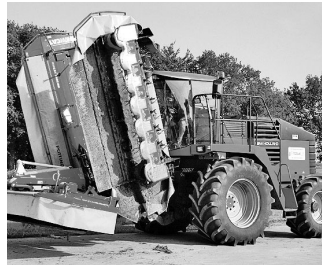
注入機輸入業のゾンナ社が開発した新型モアは、刈取装置を前傾させてオペレータの視界を広げた。
