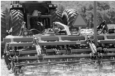
カルチベータ「ターボ・ティル」は、時速11〜13kmの前進速度で最高の結果を出すと、製造元のグレート・プレーンズ・マニュファクチュアリング社は話す。
