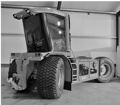
ブレド社の自走式車両トラク（VT2716 HSモデル）は最高時速60kmで走行できる。
