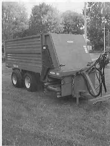
モレマ社製マニアスプレッター。タイヤの端から端まで1.4mというスリムな横幅。家畜の給餌機のような外観だ。
