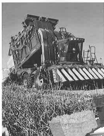
これまで収穫後の綿花は、トレーラへ積み込まれてから、据付式のモジュール（綿花を固めたブロック）作成機に搬送されていた。ケースIH社の綿花収穫機「モジュール・エクプレス625」なら、収穫作業をしながら同時にモジュールを作る。
