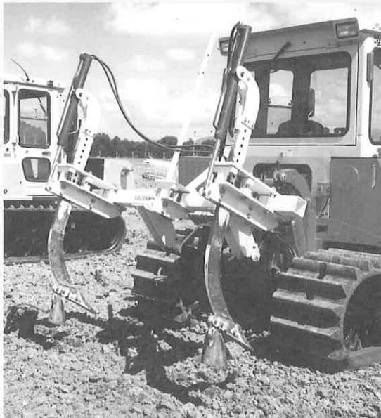
写真8) 雪上心破用心土破碎機
