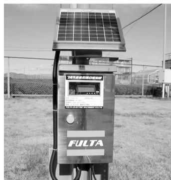
圃場に設置された「有効積算表示器」。ランプの色で防除適期を判断できる。
