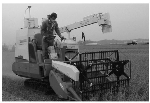
コンバインの後部に各種センサ、制御装置を搭載。後部にはGPSアンテナが見えるアーム状に前方へ伸びているのが排出量センサ。
