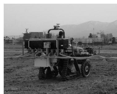
散布量を決める繰出しロールの回転数を自動制御。
