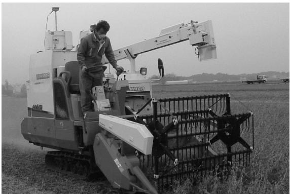
コンバインの後方部に各種センサ、制御装置を搭載。後部にはGPSアンテナが見えるアーム状に前方へ伸びているのが排出量センサ。
