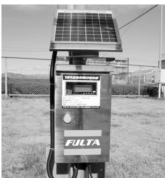
圃場に設置された「有効積算表示器」。ランプの色で防除適期を判断できる。
