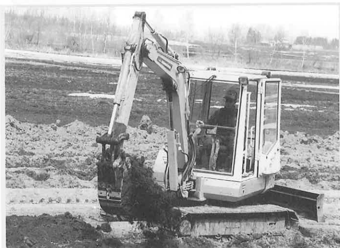
写真5) ナガイモ収穫に活躍するミニバックホー バックホーはトレンチャに比較すると高価であるが、高能率であるばかりでなく、利用範囲が広く、利用経費が負担になるものではない。例えば、排土板は収穫後の埋め戻しに利用できる。アースオーガを装着して杭を立てるための穴掘りも容易であり、マニュアルバケットに取り替えて堆肥の切返しや積み込みに活躍する
