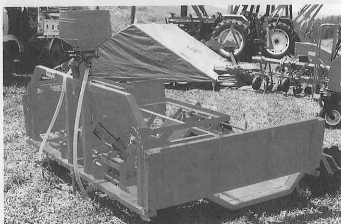
写真6) ナガイモプランタ 北海道のナガイモは切片栽培が主流である。催芽した芽を上にして植付けしなければならないことから、植付けの機械化は無理とされていた。種子を台に乗せ、植付けを手で行うだけでも大幅な軽労働化であることから、プランタの開発が進められたが、スタータの肥料を側条に施肥できるとか、覆土深さを均一に保つことなどが発芽、初期生育を良好にすることに結びついた
