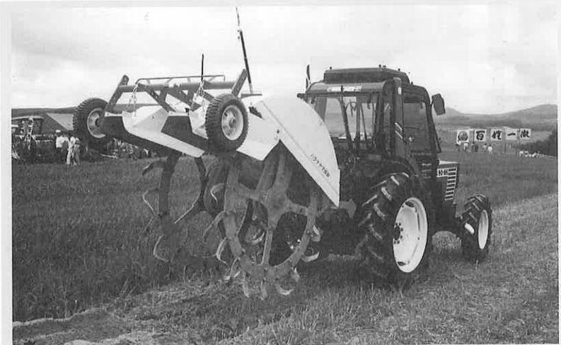
写真1) ホール型部分深耕ロータリ ナガイモの植付床造成はトレンチャで行うと言われるように、当初、ラダーチェーン型のトレンチャを改良したものが使われた。ラダーチェーン型は高価である。メンテナンス負担も大きいなどとされて、単純な構造のホール型が開発された。土壌の碎土、混和状態などが若干異なるが、作物の生育には問題はない
