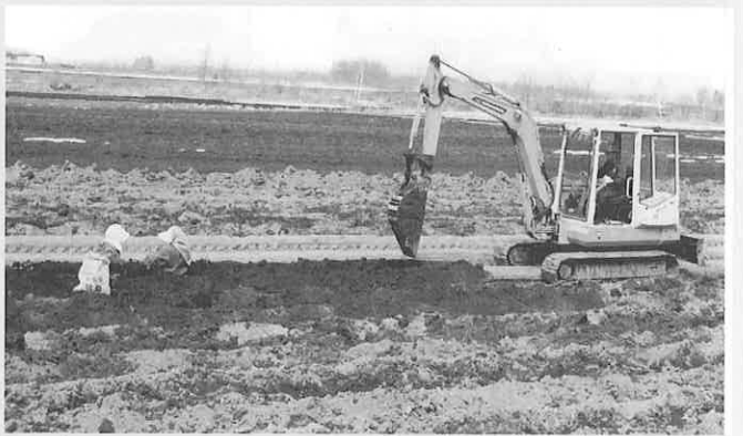
写真4) ミニバックホーによる収穫溝掘削
