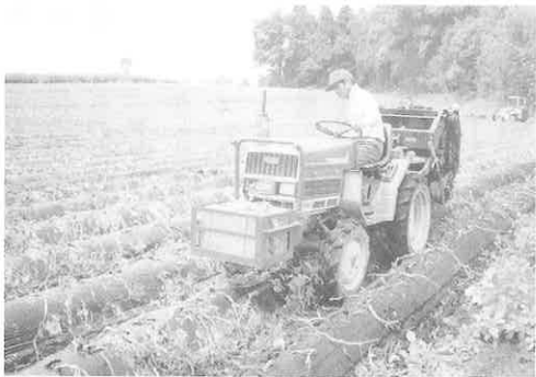
＜高穂さん圃場の収穫作業＞撮影日平成9年5月30日 マルチ剥ぎ機（ロールペラの改造型）。従来の手作業では10a当り4時間かかる作業が、マルチ剥ぎ機では10a当りを1時間程でできる。トラクタは、14馬力(通常は18馬力位がベース)で前に120kgのウエイトをしてマルチを剥ぎ取る。
