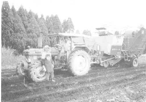
＜収穫作業＞撮影日平成9年5月30日 大型収穫機ハーベスタTPH55。トラクタは、フォードの48馬力の四駆で楽に収穫します(通常はトラクタ55馬力以上がベースとなります)。圃場条件がよければ、10a当りを1時間程で収穫していきます。従来の手作業体系では、1日1人で3a程の収穫でしたが、重労働もなく、機械の上で選別作業をするだけですごく楽に収穫されます。ハーベスタ55の前で、高穂さんとお母さんを収穫作業終了後撮影
