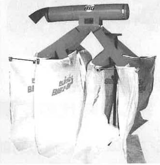
ダクト本体の中に斜めに設置されているステンレス製の網が、粉殻と風を分離させ、粉殻袋の中にすべての粉殻を収集、小さなほこりの混じった空気は外に排出させる。排出口は8個ある高能率型で、袋が満杯になんでも差込み式のシャッターが独立しているので、袋交換の際でも機械本体を停止する必要がない。希望小売価格62,000円。
