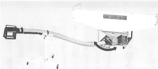
スワイング式ホッパと調節式粉受板により投入口高さが自在に調節できるため、メーカーを問わずどんなダンプカー(2tダンプでも可能)からでも粉投入できる。トラックコンペアのバネコンを使用している。搬送能力は毎時9~12t。ワンタッチ着脱バネコンとキャスター付ホッパにより移動が容易である。希望小売価格256,800円。
