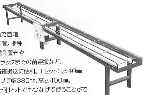
モーター駆動で苗箱を運ぶ搬送装置。播種時の苗箱の据え置きや田植え時のトラックまでの苗運搬など、ハウス内の苗箱搬送に便利。1セット3,640mmのロングタイプで幅380mm、高さ400mm。連結式なので何セットでもつなげて使うことができ連結部にターンテーブルを使えば90度までの角度で方向転換ができる。希望小売価格57,000円。
