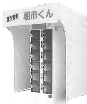
畑で収穫した農作物を無人販売するための100円硬貨専用の自動販売機。畠脇や道路横に設置されることから、直射日光によって庫内温度が上昇しないよう、壁面に発泡スチロール材を使用、さらに換気扇が付いている。料金設定は各室それぞれ200、300、400円の3段階で設定でき、1度設定しても自由に変更可能。希望小売価格298,000円。
