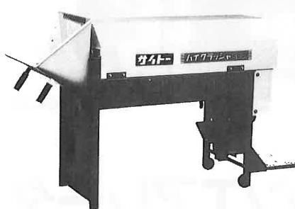
面積の広い網が揺動しており、又スクレッパー内蔵によって土の乾燥が不充分でも目詰りの心配がない高能率の碎土機。強力なローターはどんな土でも能率良く
