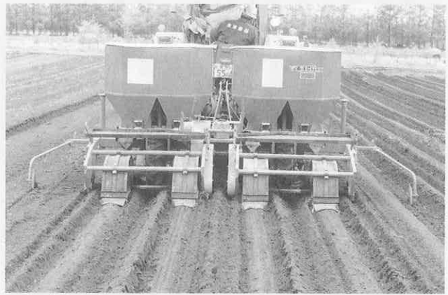
写真1) 混合装置付ロータリ施肥機 肥料を混合しながら排出し、土壌に混和する。化成肥料は粒状になっているので取扱いやすいが、単肥の場合、形状も比重も異なるので、何種類かを同時に施用しようとするとう分離して均一な施肥ができないことがある。混合装置が付いていると、タンク内で混合できるばかりでなく、分離を抑えるので正確な施肥ができることになる
