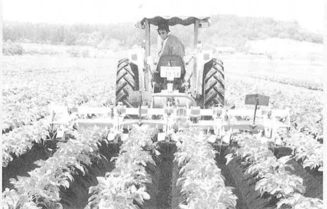
写真3) ロータリ整畦培土機 整畦培土は「かまぼこ培土」「ふっくら培土」などの愛称で親しまれているが、粘質土地帯ではロータリカルチベータに装着する。砕土されて培土されるので、茎葉を傷めることなく、正確に培土する。完璧を期す農家は軽しよう土地帯にも利用している。整畦部にはプラスチック板を使用している。これはプラスチックはつ土板ブラウの技術を応用したものである。土壌の付着が全くないので、綺麗な仕上がりであり、わが国ならではの技術である
