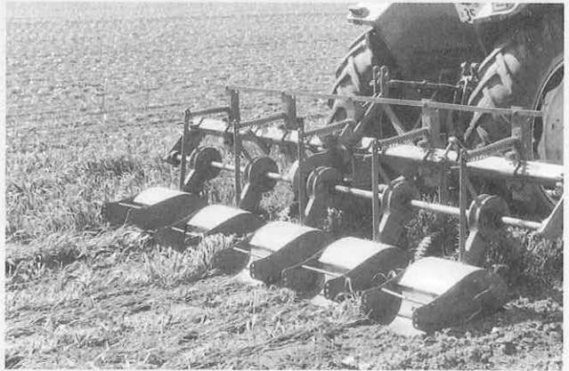
写真2) ロータリカルチベータ 畦間の雑草を完全に潰そうとすると、ロータリカルチが効果的である。また、側板の開閉調節で株間に土壌を飛ばし、覆土で株間の雑草の繁殖を抑制することもできる。畦間に十分に砕土されていると、次のカルチベータによる土寄せ、小培土を正確に行うことができ、株間の手取り除草の労働負担を軽減する
