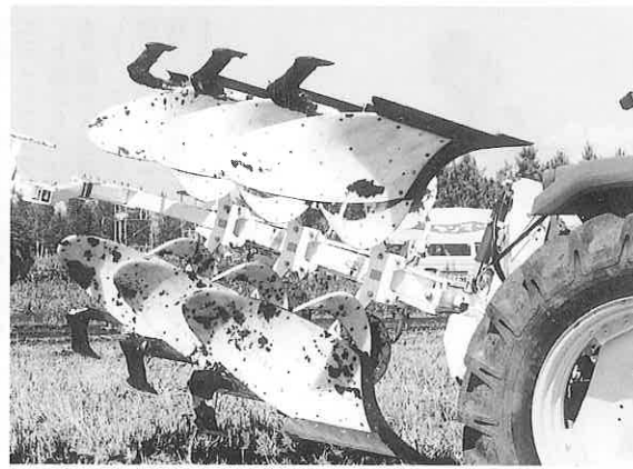
写真2) 側耕型心土耕プラウTS16R/L・12 心土犁はボトムの後部に位置し、プラウ耕と同時に犁底を破碎する。ボトム幅の間隔で心土破碎することから、破碎にムラがなく、排水性改善効果は大きい。大型トラクタが普及している現在、効率利用面から改めて注目されている。心土犁はアタッチメントで各種プラウに装着できる
