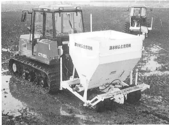
写真4) 疎水材心土充填機 (初三郎) 粉殻心破と考えればよい。当初の粉殻心破の特許名称は夾雑物充填装置付き心土破碎機だったのである。水田の場合は粉殻が豊富であり、無尽蔵である。収穫したものは戻すと言う循環農法の建て前からも粉殻を使うのが正しい。粉殻に不足する畑地では粗粒火山灰などでもよく、木材のチップを利用する考えもある
