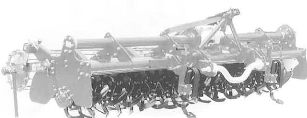
ソイルルーズナ付きロータリハローの跡消しと言われるが、スプリングタインのソイルルーズナが装備されている。トラクタのタイヤで踏圧した部分を膨脹にし、全層均一な土壤条件にしようとするものである。ゲージホイールを装備しないで大丈夫かと不安に思われるかもしれないが、それは後部の鎮圧ケージローラで代替してもよいことであり、日本のトラクタは電子制御の自動深耕調節も付いており、それを利用すればよいことである。水田であれば、最近話題のレーザを使用してもよい
